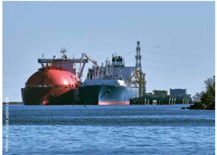
LNG-Tanker bei der Entladung im Hafen von Klaipėda unter Nutzung eines schwimmenden LNG-Terminals (FSRU) zur Einspeisung in das litauische Erdgasnetz
