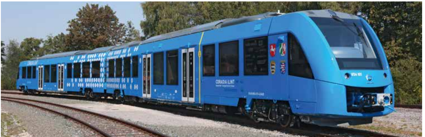
Sinnvolle Wasserstoffanwendung: Der Coradia iLint von Alstom ist der erste Zug mit Brennstoffzellen-Antrieb zum Einsatz auf Strecken mit fehlender Oberleitung.
