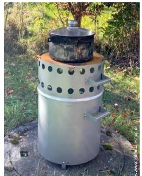
Kleine Pyrolyseöfen mit Volumina von 5 bis 15 Liter sind häufig als Holzvergaseröfen mit einer Kochplatte gestaltet. Hochwertige Varianten aus Edelstahl sind ab 230 Euro erhältlich.
